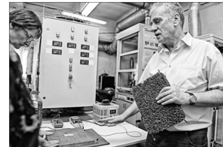
Сергей ЖДАНОК показывает бетон, способный прогреваться.
