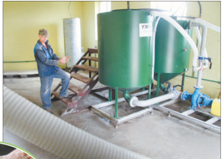
Сёлета ў гаспадарцы ўведзена ў эксплуатацыю новая ўстаноўка для вытворчасці патакі з размолатай сумесі збожжавых культур. Гэтае прыстасаванне забяспечвае каштоўнай дабаўкай увесь статак буйнай рагатай жывёлы.
