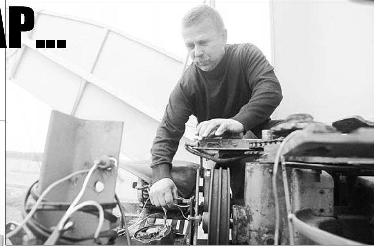
Жыхар вёскі Новая Паддубы Шуцькага раёна Матэўс СІНКВЯЧУС сваімі рукамі сабраў і ўсталяваў у сябе на участку ветрагэнэратар. У якасьці назапашальніка энэргіі прыставаў старыя акумулятарныя батарэі, з дапамогай каробкі перадач ад «Волгі» кантралюе хуткасць кручэння генэратара. 16-мэтровы ветрагэнэратар пры добрым ветры вырабляе 5 кВт. Цяпер Матэўс Сінквячус працуе над павелічэннем магутнасці ветранай электростанцыі да 18 кВт, каб з яе дапамогай абагнаваць майстэрні.
