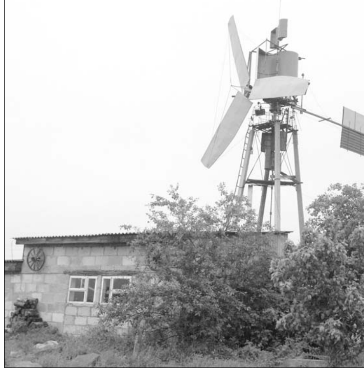
Жыхар вёскі Новая Паддубы Шуцькага раёна Матэўс СІНКВЯЧУС сваімі рукамі сабраў і ўсталяваў у сябе на участку ветрагэнэратар. У якасьці назапашальніка энэргіі прыставаў старыя акумулятарныя батарэі, з дапамогай каробкі перадач ад «Волгі» кантралюе хуткасць кручэння генэратара. 16-мэтровы ветрагэнэратар пры добрым ветры вырабляе 5 кВт. Цяпер Матэўс Сінквячус працуе над павелічэннем магутнасці ветранай электростанцыі да 18 кВт, каб з яе дапамогай абагнаваць майстэрні.
