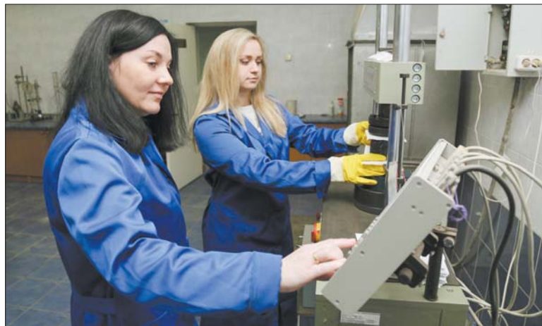
У лабараторыі займаюцца разробкай і выпрабаваннем дарожна-будаўнічых матэрыялаў. Тэхнік-лабарант Святлана ДАМБРОВА і тэхнік Рыта ХМЯЛЬНІЦКАЯ на спецыяльным прэсе правяраюць якасць асфальтабетону.
