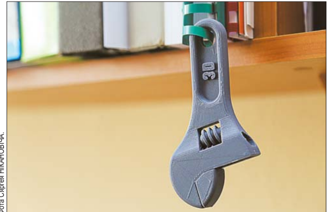
Такія гаечныя ключы друкуюць на 3D-прінтарах у якасці сувеніраў. Але інструмент — у працоўным стане.
