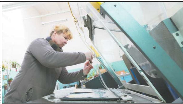
На машыне «Тытан» брайлеўскі тэкст з металічных пласцін пераносіцца на паперу з дапамогай ціску.
