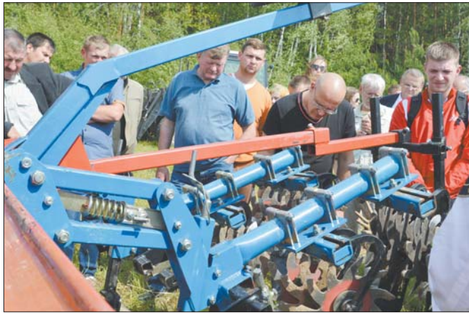
Сеткаватая барана і роліка-зорчаты культыватар — тэхніка, якая не шкодзіць глебе і дазваляе эфектыўна справіцца з пустазеллем.
