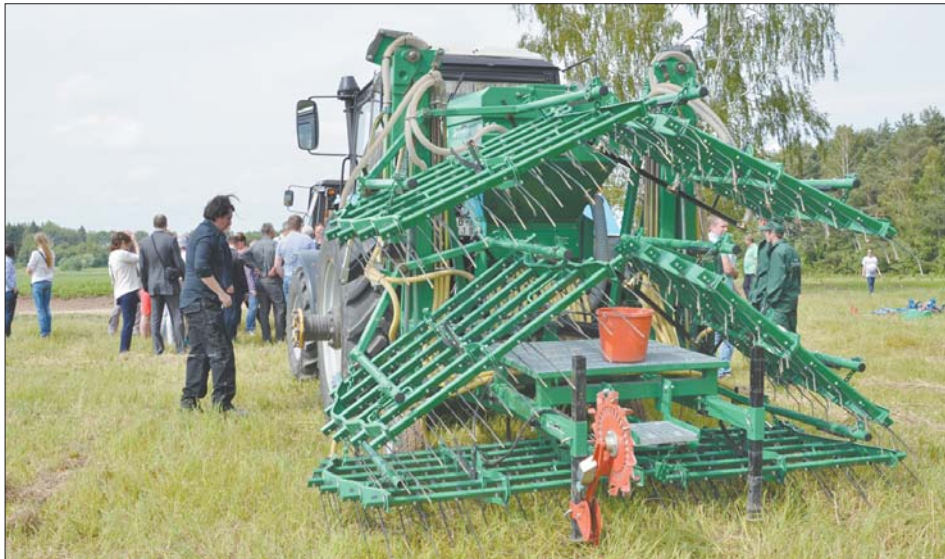
Сеткаватая барана і роліка-зорчаты культыватар — тэхніка, якая не шкодзіць глебе і дазваляе эфектыўна справіцца з пустазеллем.
