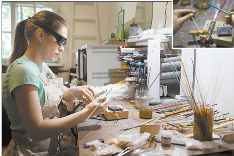
Шкляная палачка разграваецца на гарэлцы і «намотваецца» на металічны інструмент. Так атрымліваецца пацеркі.
