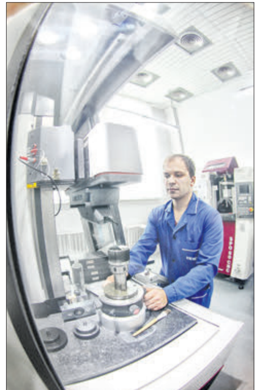
Оптык Яўгеній КОРЗАН кантралюе якасць паліроўкі асферычных лінзаў.
