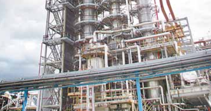
Устаноўка экстракцыйнай дэстыляцыі бензолу.
