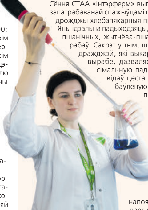
Інжынер-хімік Таццяна ВАРАШКЕВІЧ вызначае жорсткасць катлавай вады ў вытворча-аналітычнай лабараторыі.
